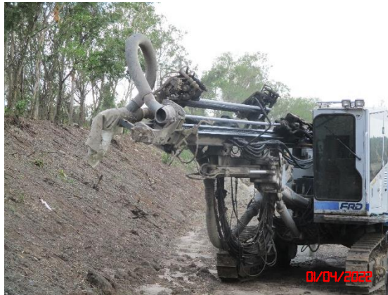
รูปที่ 2-19 รถเจาะรูระเบิดที่มีอุปกรณ์เก็บฝุ่นละอองติดไว้กับหัวเจาะ
